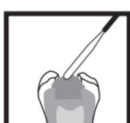
6. Les surfaces exposées peuvent être directement couvertes d'une mince couche de mélange. Pulvériser avec de l'eau tiède pour accélérer la prise.
