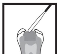
6. Las áreas descubiertas pueden cubrirse directamente con una mezcla diluida. Rocíe con agua caliente para acelerar el tiempo de fraguado.
